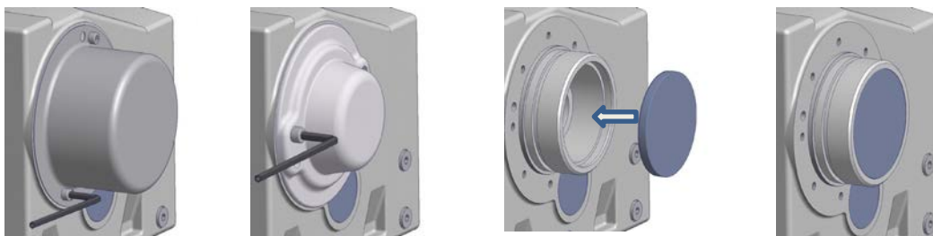
Afbeelding 15: Montage van de afdekkap optie SH, optie H en optie H66
