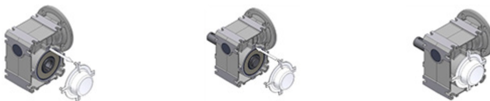
Fig. 16: Demontering og montering av dekselheten
