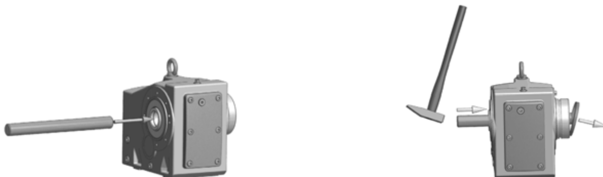
Rysunek 7: Demontaż fabrycznie zamontowanej pokrywy zamykającej
