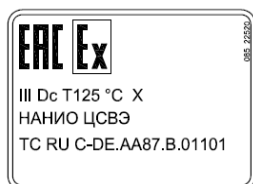
Rysunek 2: Dodatkowe tabliczki znamionowe dla EAC Ex
