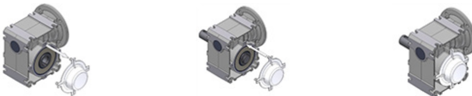
Figura 16: Desmontagem e montagem da tampa de proteção
