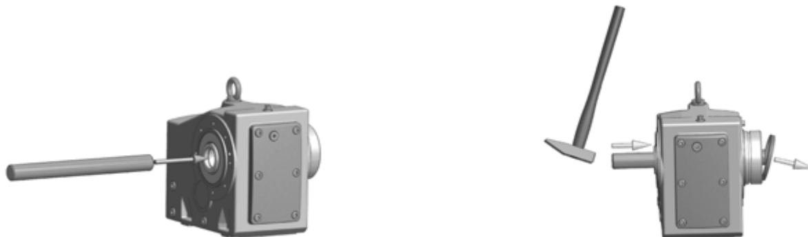
Figura 7: Desmontagem do tampão montado de fábrica
