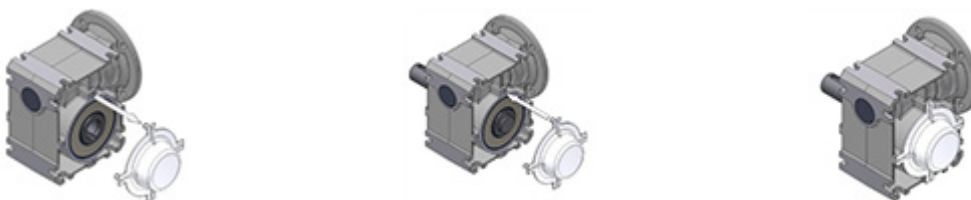
Рис. 16: Монтаж и демонтаж колпака
