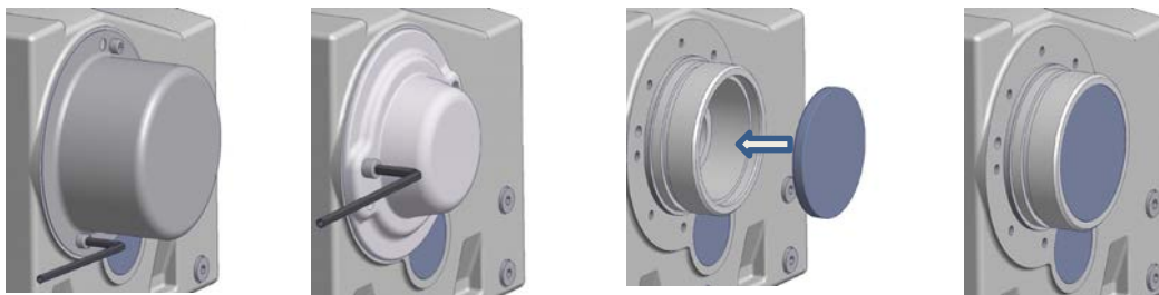
Slika 15: Montaža zaščitnega pokrova, opcija SH, opcija H in opcija H66
