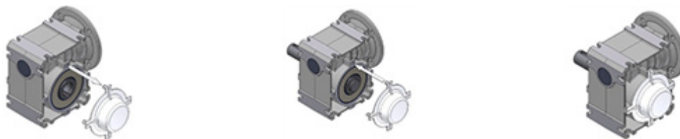
Slika 16: Demontaža in montaža zaščitne kape
