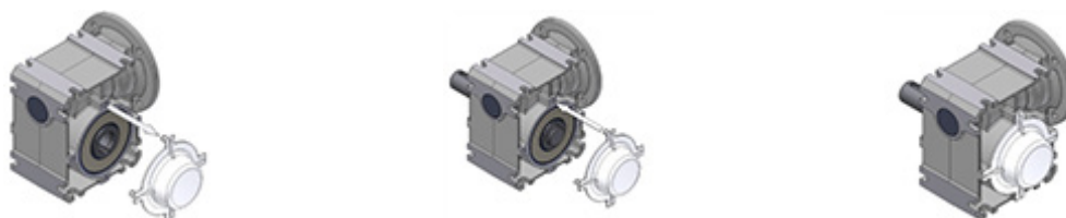
Slika 16: demontaža i montaža pokrivne kapice
