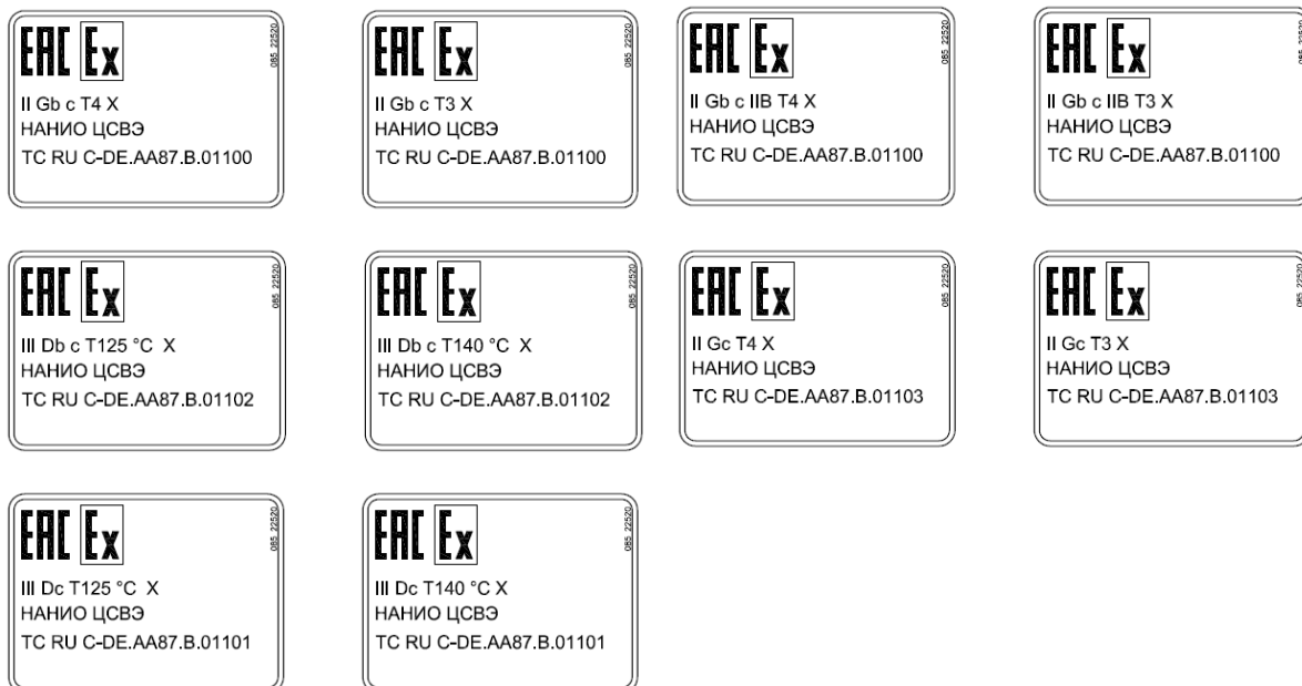
Abbildung 3: Zusatztypenschilder für EAC Ex
