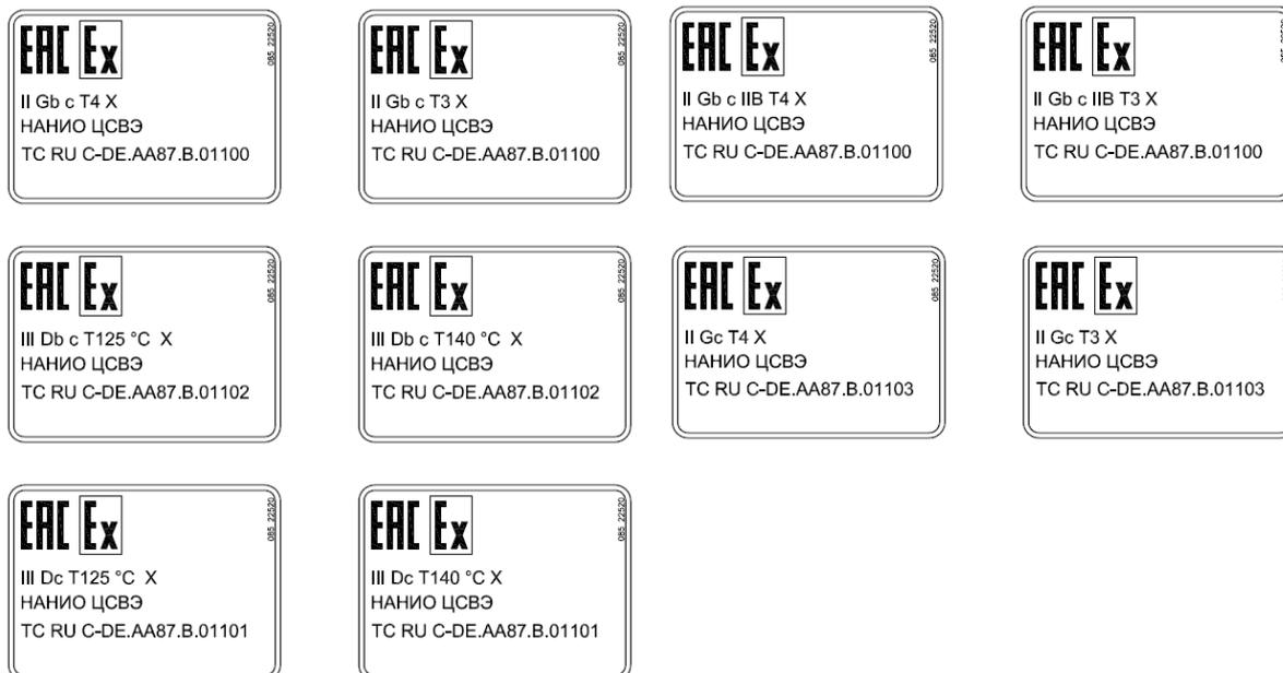
Figura 3: Placa de características adicional para EAC Ex
