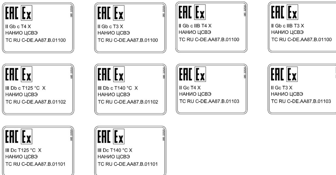
Figura 3: Placas de identificação adicionais para EAC Ex
