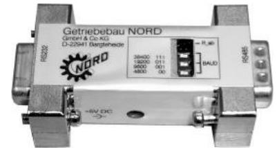
**Hinweis:** Zur Stromversorgung (5V/250mA) dient ein lieferbarer Adapter vom PC- USB-Port zum Umsetzer. Beachten Sie dabei bitte, dass der USB-Port für *HighPower*-Geräte geeignet ist. Eine angeschlossene ParameterBox wird über diese 5V mitversorgt.
