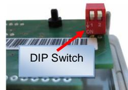
Sind die DIP – Schalter auf *Auto – scan* konfiguriert und wird beim scan – Vorgang kein Teilnehmer detektiert, wechselt die Box automatisch in die Betriebsart IO-S.
