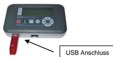
Der Anschluss an die jeweiligen Frequenzrichter erfolgt über die entsprechend am Gerät vorhandenen RJ-12 Anschlussbuchsen. Die SimpleBox SK CSX-3H kommuniziert ausschließlich mit Frequenzrichtern.
