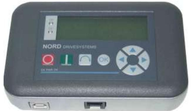
Pour la connexion sur un PC / ordinateur portable, seul un câble USB courant (connecteur de câble de connexion USB2.0 série A sur connecteur série B) est nécessaire.
