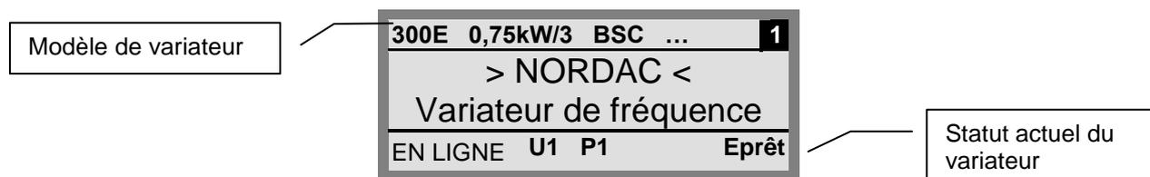
Dans le mode d'affichage standard, il est possible d'afficher simultanément 3 valeurs de fonctionnement et le statut actuel du variateur de fréquence.
