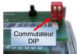
Si les commutateurs DIP sont configurés sur *Auto – scan* et que lors du scannage aucun participant n'est détecté, la console passe automatiquement en mode de fonctionnement IO-S.
