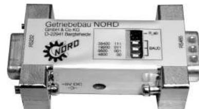
**Remarque :** pour l'alimentation électrique (5V/250mA), l'adaptateur du port USB PC fourni sert de convertisseur. Il convient de noter que le port USB est approprié pour des appareils *HighPower*. Une ParameterBox connectée est alimentée par cette tension de 5V.
