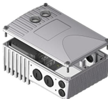
4. Na base da caixa de ligação do motor NORD montar a carcaça do SK 1x5E com os parafusos e vedante existentes bem como as arruelas dentadas / de contato fornecidas. A carcaça deve ser alinhada de tal forma que o lado arredondado aponte para a direção da placa de mancal A. Realizar a adaptação mecânica mediante o "Conjunto adaptador" (📖 Seção 2.1.1.1 "Adaptação ao tamanho do motor"). Para motores de outros fabricantes deve ser verificada sempre a montabilidade.
