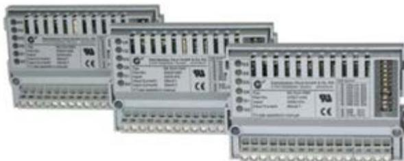
Figura 8: interfaces internas do cliente SK CU4 ... (exemplo)
