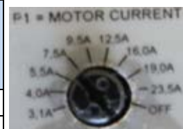
Рисунок: P1 пускового устройства двигателя на 7,5 кВт
