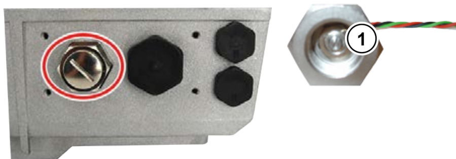
1 Regelwaarde-instelling met een schroevendraaier
