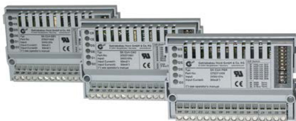
Abbildung 3: Optionsbaugruppen SK CU4 ... als interne Kundenschnittstellen (Beispiel)
