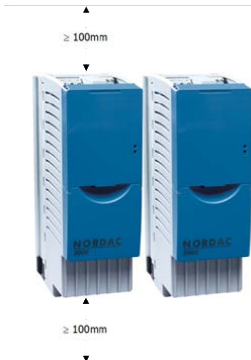
Abbildung 1: Montageabstände SK 5xxE
