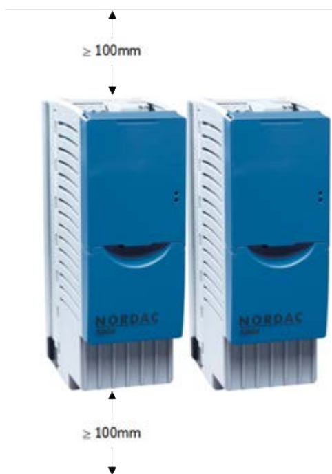
Рис. 1: Монтажные расстояния SK 5xxE
