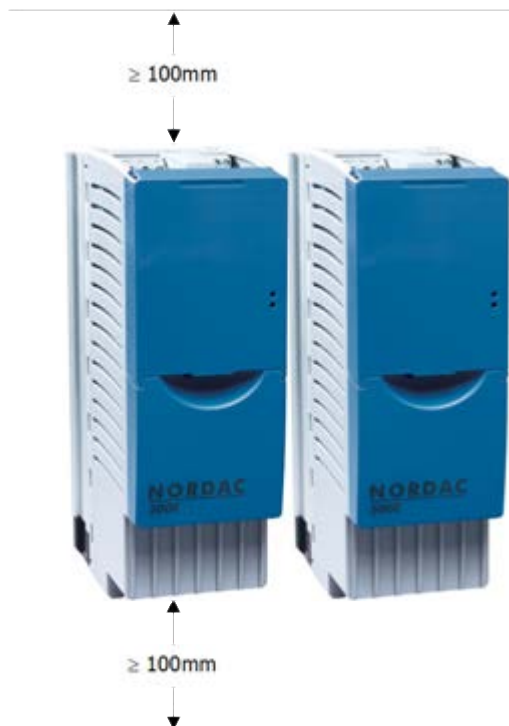
Abbildung 1: Montageabstände SK 5xxE
