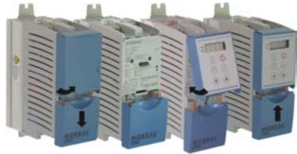
Auf einwandfreie Kontaktierung der Steckerleiste achten und bei Bedarf mit passender Schraube (Blechschaube 2,9 mm x 9,5 mm im Lieferumfang des Frequenzumrichters enthalten) fixieren.
