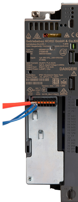
Fixieren der Anschlüsse (dritte Hand)
