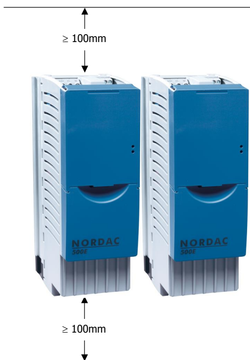
图 1：SK 5xxE 的安装距离
