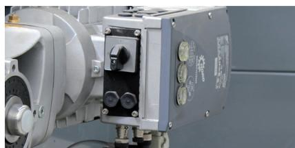
开关和按钮均直接布置在驱动设备处, 允许直接启动、停车和改变模式。
