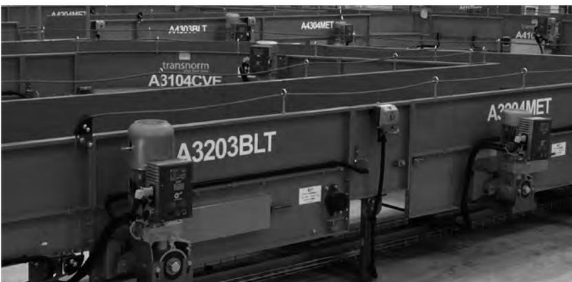
用于驱动包裹配送中心的水平输送带的变频一体机
