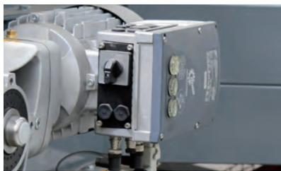
可直接通过驱动装置上的开关和按钮实现启动、停止和模式更改操作
