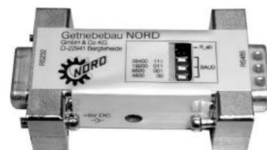
**注意:** 可以提供适配器, 由 PC 的 USB 端口为转换器供电 (5V/250mA)。请确保 USB 端口适用于大功率设备。该 5V 电源同时也为连接的参数盒供电。
