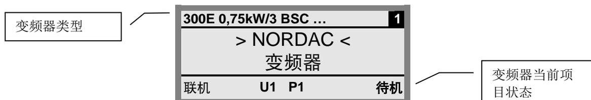
在标准显示模式下，可同时显示 3 个操作值和当前变频器状态。
