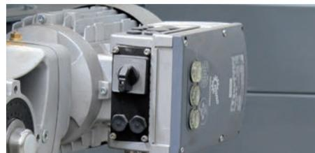
可直接通过驱动单元上的开关和按钮立即实现启动、停止和模式设置操作。
