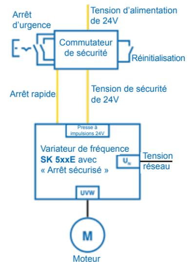
**Protection anti-accident.** Un blocage sûr des impulsions empêche le moteur de redémarrer lorsque le capot ou la porte de protection est ouvert.
