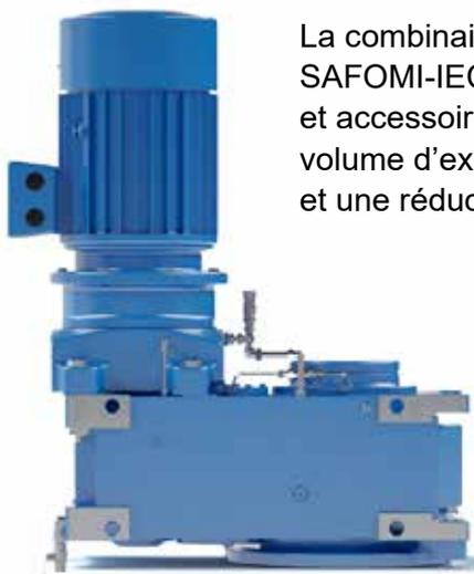
La combinaison compacte du réducteur industriel MAXXDRIVE® et de l'adaptateur SAFOMI-IEC est parfaitement appropriée pour les agitateurs. Les pièces d'usure et accessoires peuvent être réduits puisque l'adaptateur SAFOMI-IEC fournit un volume d'expansion d'huile intégré. Une plus grande sécurité de fonctionnement et une réduction des frais d'entretien en résultent.
