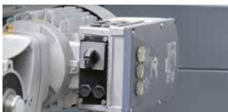
Les commutateurs et boutons sont directement disposés sur les entraînements et permettent le démarrage direct, l'arrêt ainsi que les modifications de mode.
