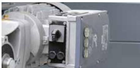
Выключатели и кнопки расположены непосредственно на приводах и позволяют осуществлять прямой пуск, останов, а также изменять режимы.
