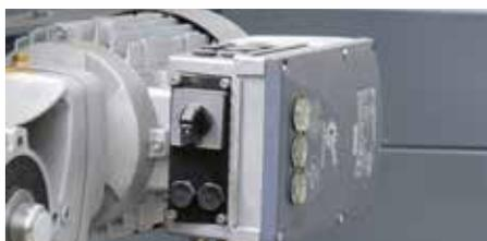
Les commutateurs et les touches sont situés directement sur les variateurs et permettent le démarrage et l'arrêt directs ainsi que la commutation de mode.
