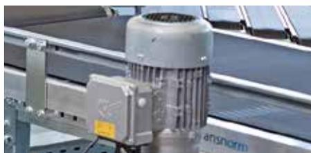
Des moteurs puissants allant jusqu'à la classe IE5 maintiennent les systèmes d'entraînement en mouvement dans toutes les situations de fonctionnement.
