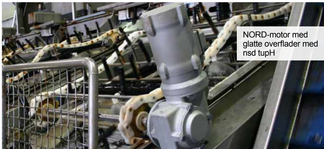
Motorer med glatte overflader
