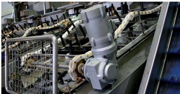
Moteur à surface lisse NORD avec traitement de surface nsd tupH
