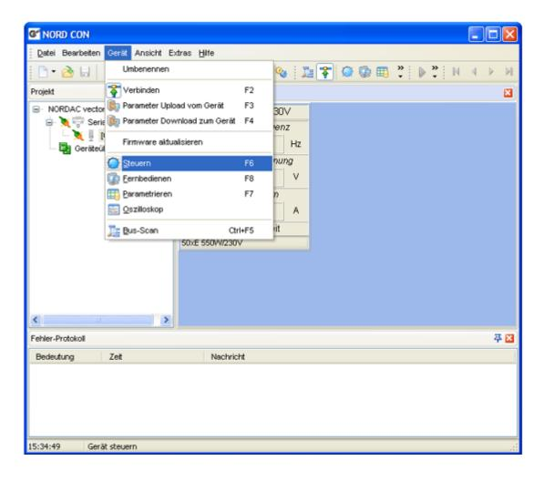
Nach dem Öffnen wird mit den Standardeinstellung ("Einstellungen/Steuern/ Steuerungskonfiguration auswerten" ausgewählt) die Steuerungskonfiguration des Gerätes eingelesen und ausgewertet. Ist das "Steuern" eingeschränkt oder nicht möglich, wird dies durch ein Warnhinweis dem Benutzer angezeigt.
