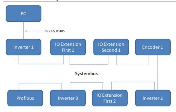
Alle am Systembus angeschlossen NORD Baugruppen können über einen Teilnehmer mit RS232/RS485 Schnittstelle über NORD CON visualisiert und parametriert werden. Hierfür werden die Kommunikationsanfragen über das an NORD CON oder Firmwareaktualisierungsprogramm angeschlossene Gerät getunnelt. Für die Tunnelung der Anforderungen wird das folgende Mapping-Verfahren verwendet:
