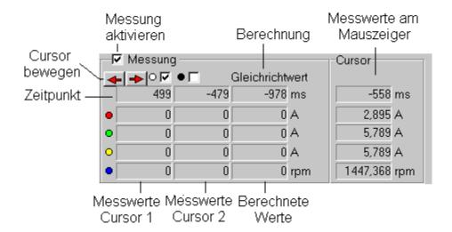
Für die Messungen stehen zwei Cursor zur Verfügung. Die Cursor können über bewegt werden. Die Auswahl des Cursors findet dabei über statt. Wenn der Mauszeiger sich über der Anzeige befindet, kann durch Betätigen der rechten Maustaste zwischen den Modi 'Move' und 'Messen' umgeschaltet werden. Im Modus 'Messen' können die Cursor durch Betätigen der linken Maustaste gesetzt werden.
