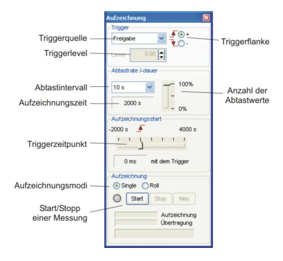
Über den Triggereinstellungen wird der Startpunkt einer Messung bestimmt. Zuerst muss die Triggerquelle festgelegt werden. Triggerquellen können zum einen die Messwerte sein, zum anderen Digitaleingänge, Umrichterzustände usw. Mit dem Triggerlevel bzw. der Triggerflanke wird der Startzeitpunkt der Messung festgelegt.
