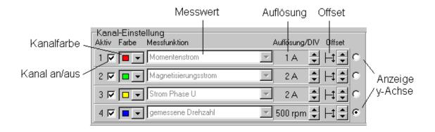
Für die Auswahl der 4 Messwerte steht jeweils ein Kombinationsfeld zur Verfügung. Jedem Kanal kann eine Farbe zugeordnet werden. Über die Checkboxen ist jeder Kanal einzeln an- bzw. ausschaltbar. Für jeden Kanal kann die Auflösung und ein Offset eingestellt werden. Bei der Darstellung der Messwerte wird die y-Achse von einem Kanal angezeigt. Dieser Kanal kann ebenfalls hier ausgewählt werden.
