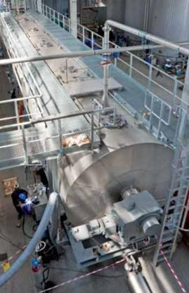
Mächtige Kegelradgetriebemotoren, paarweise an den Mischtrommeln installiert, liefern maximale Ausgangsdrehmomente von über 53.000 Nm
