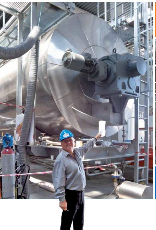
In vier 20 m langen Mischtrommeln sorgen paarweise an der durchlaufenden Welle montierte Kegelradgetriebemotoren für Bewegung
