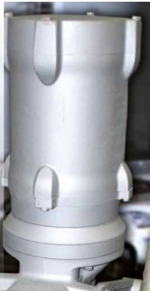
Motorreductor con tratamiento para superficies nsd tupH después de 12 meses en servicio
