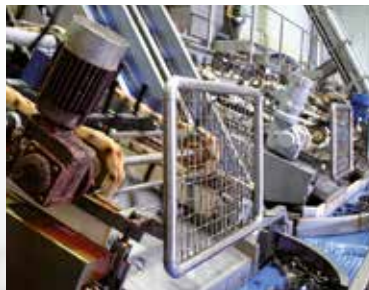
Motorreductor pintado después de 12 meses de servicio
