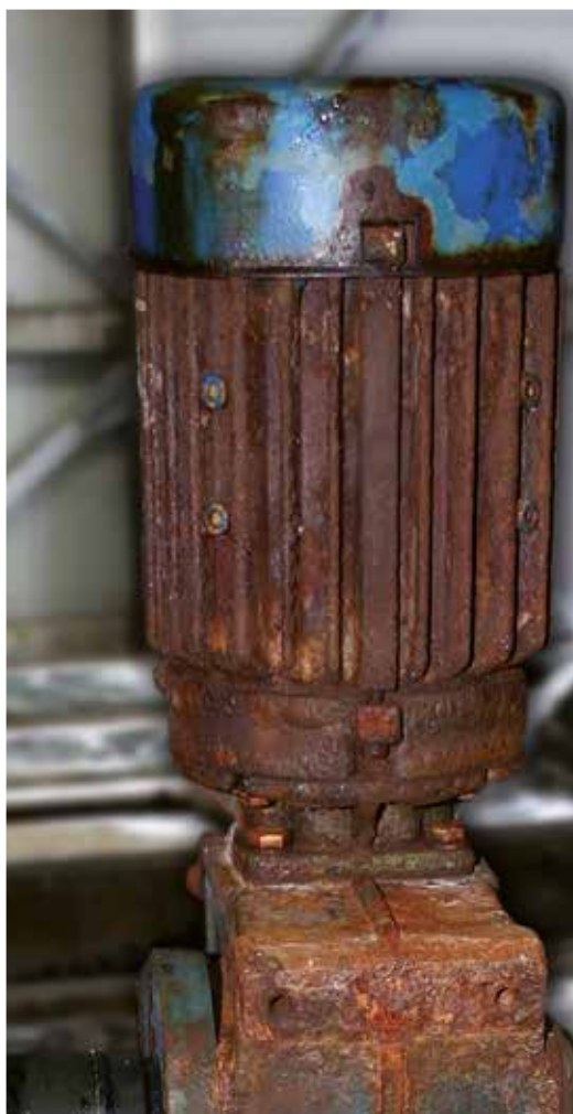
使用 12 カ月後の塗装されたギヤモーター
