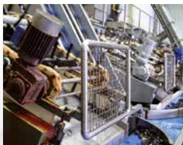
使用 12 カ月後の塗装されたギヤモーター
