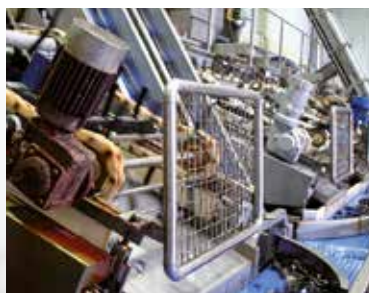
Lackierter Getriebemotor nach 12 Monaten Betriebsdauer
