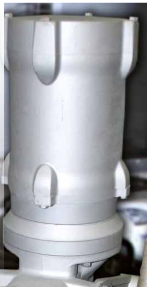
Getriebemotor mit nsd tupH- Oberflächenveredelung nach 12 Monaten Betriebsdauer
