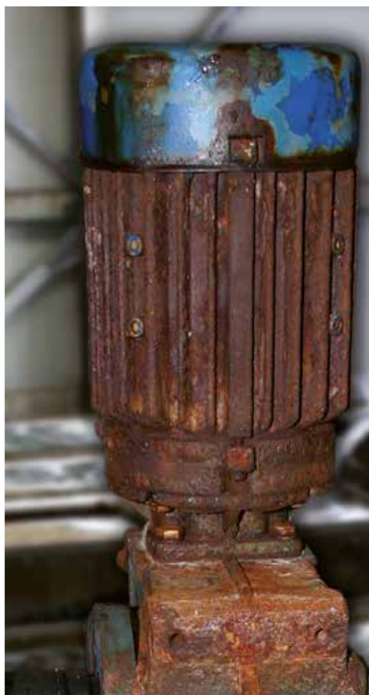
Lackierter Getriebemotor nach 12 Monaten Betriebsdauer
