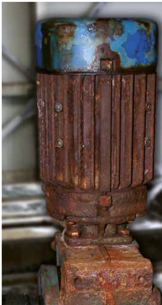
Gelakte motorreductor na 12 maanden bedrijfsduur
