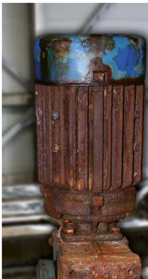
Motoriduttore verniciato dopo 12 mesi di servizio
