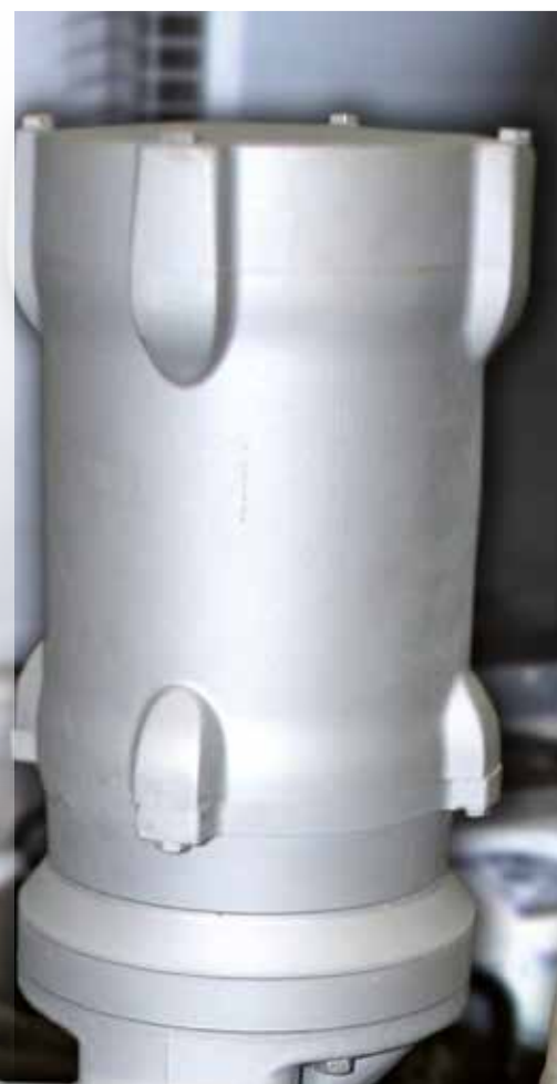
Motoriduttore nsd tupH dopo 12 mesi di servizio
