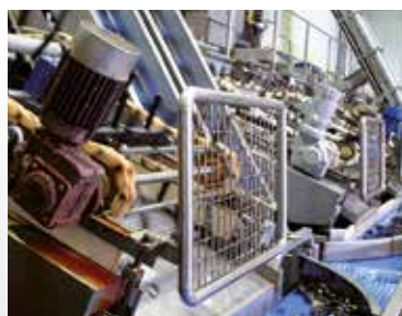
Motoriduttore verniciato dopo 12 mesi di servizio
