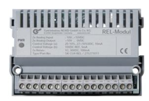
Die Klemmenleiste ist in zwei Potentialebenen (Potentialtrennung maximal 50 V DC) aufgeteilt. Diese sind bei Auslieferung durch einen steckbaren Jumper miteinander verbunden.
