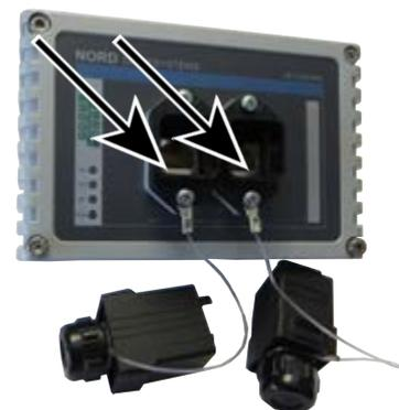
Der Anschluss der anderen Signal- und Steuerleitungen erfolgt über die Bus-Anschlusseinheit **SK TI4-TU-BUS(-C)**.
