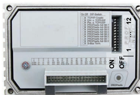
Werkseinstellung DIP-Schalter: OFF
