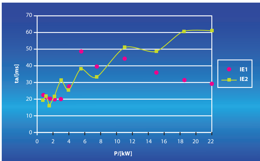
Obr.3 – čas rozběhu naprázdno motorů IE1 (značeno EFF2) a IE2
