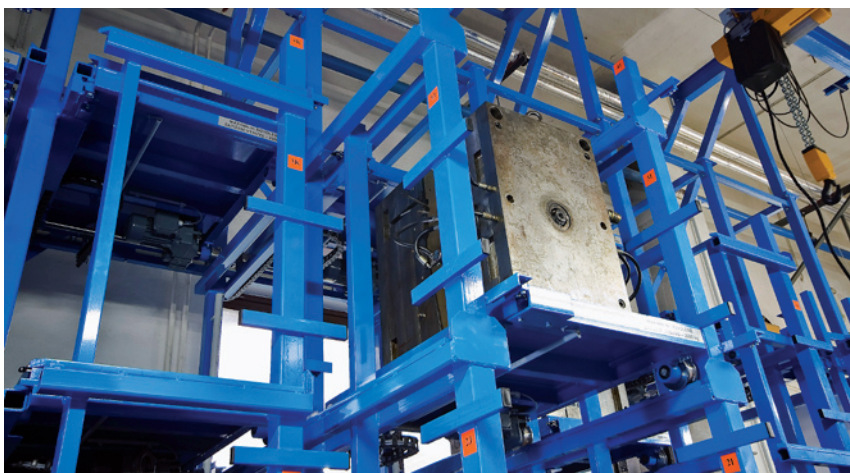
Zásobníky drivebox – sklad forem firmy vyrábějící plastové komponenty pro automobilový průmysl
