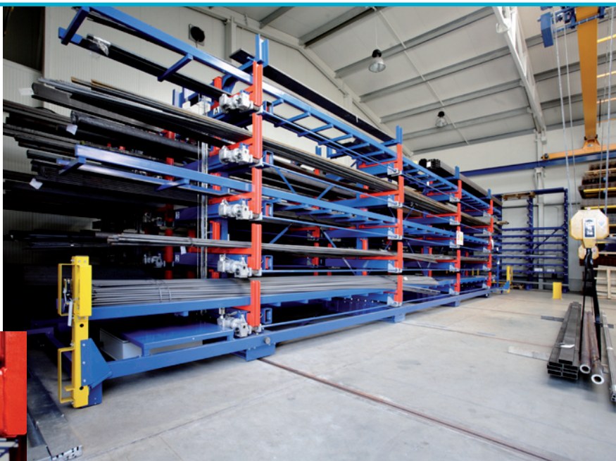
Teleskopické regály pro manipulaci jeřábem (ZJP) – sklad hutního materiálu
