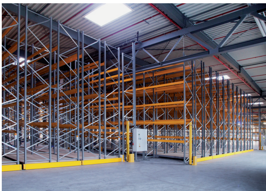
Sklad s pojízdnými regály v továrně na armatury
