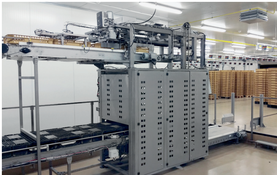
Manipulátor – ukládání přepravek na palety
