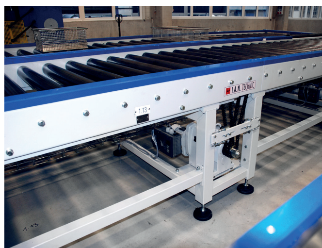
Válečkový dopravník s decentrálním měničem frekvence
